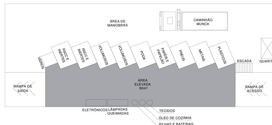
Figura 36 - Modelo conceitual de PEV ou Ecoporto Fonte: Concremat para o Plano de Saneamento 2012
